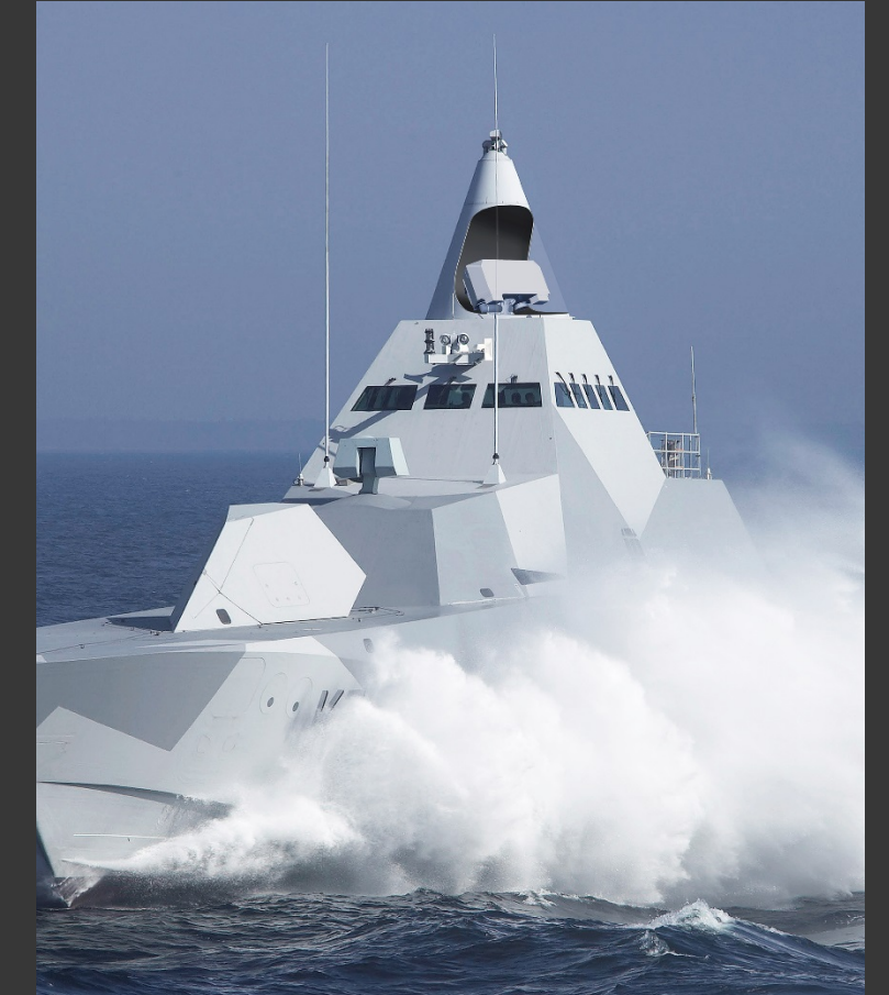
9LV and Sea Giraffe AMB integrated on Visby corvette
